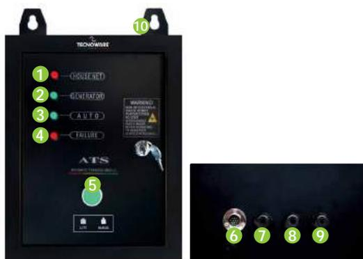
L'ATS controlla la rete elettrica e ricarica la batteria del Generatore. In caso di blackout, avvia automaticamente il motore del Generatore e alimenta i dispositivi connessi. Quando il Blackout è terminato, l'ATS alimenta nuovamente tramite la rete elettrica i dispositivi connessi, carica la batteria del Generatore e spegne, successivamente, il motore del Generatore.
